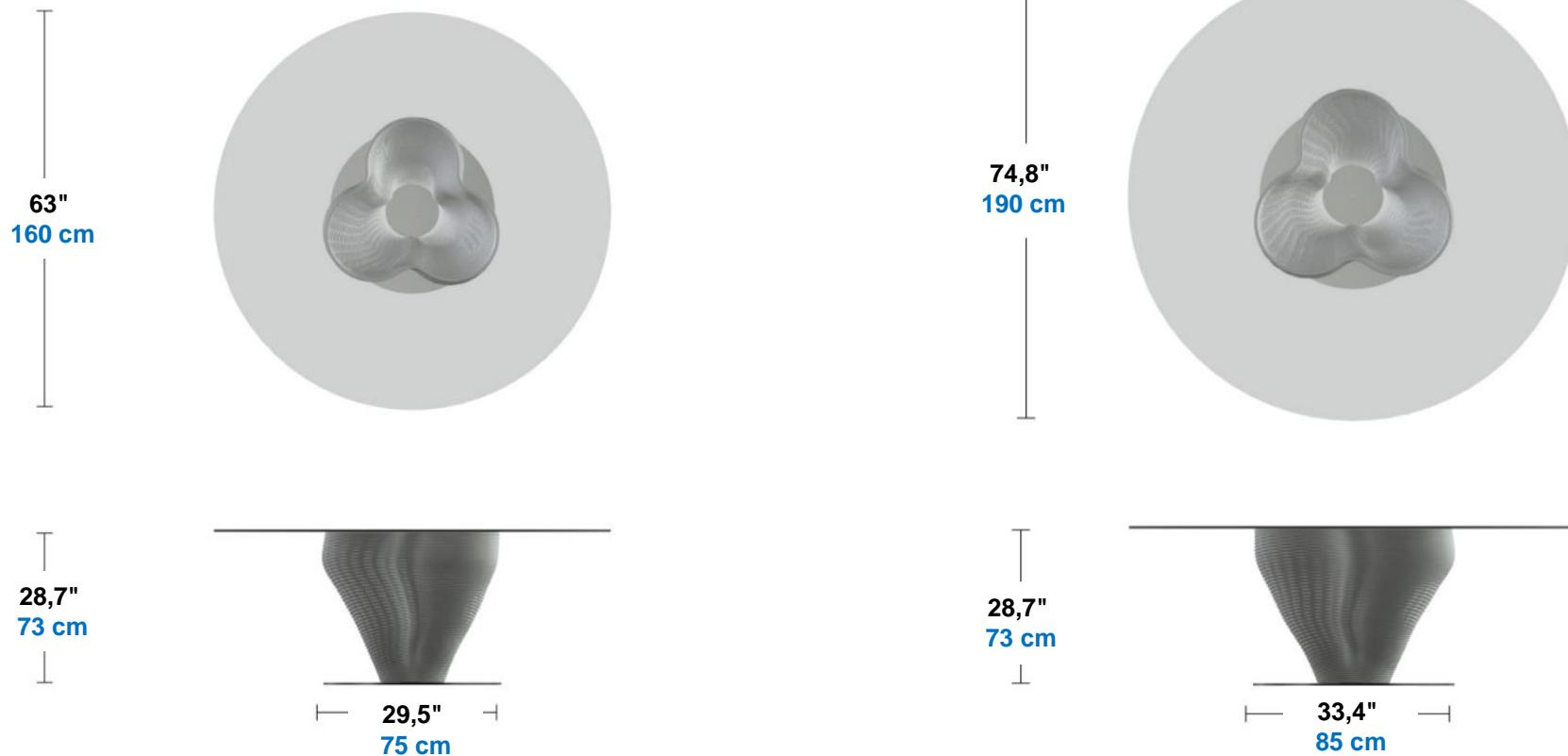
Table repas ronde avec piétement réalisé par impression 3D de béton (BUHP), personnalisable en forme et texture. Platine en acier (laque époxy, 2 coloris), plateau en verre trempé ép. 15mm.
