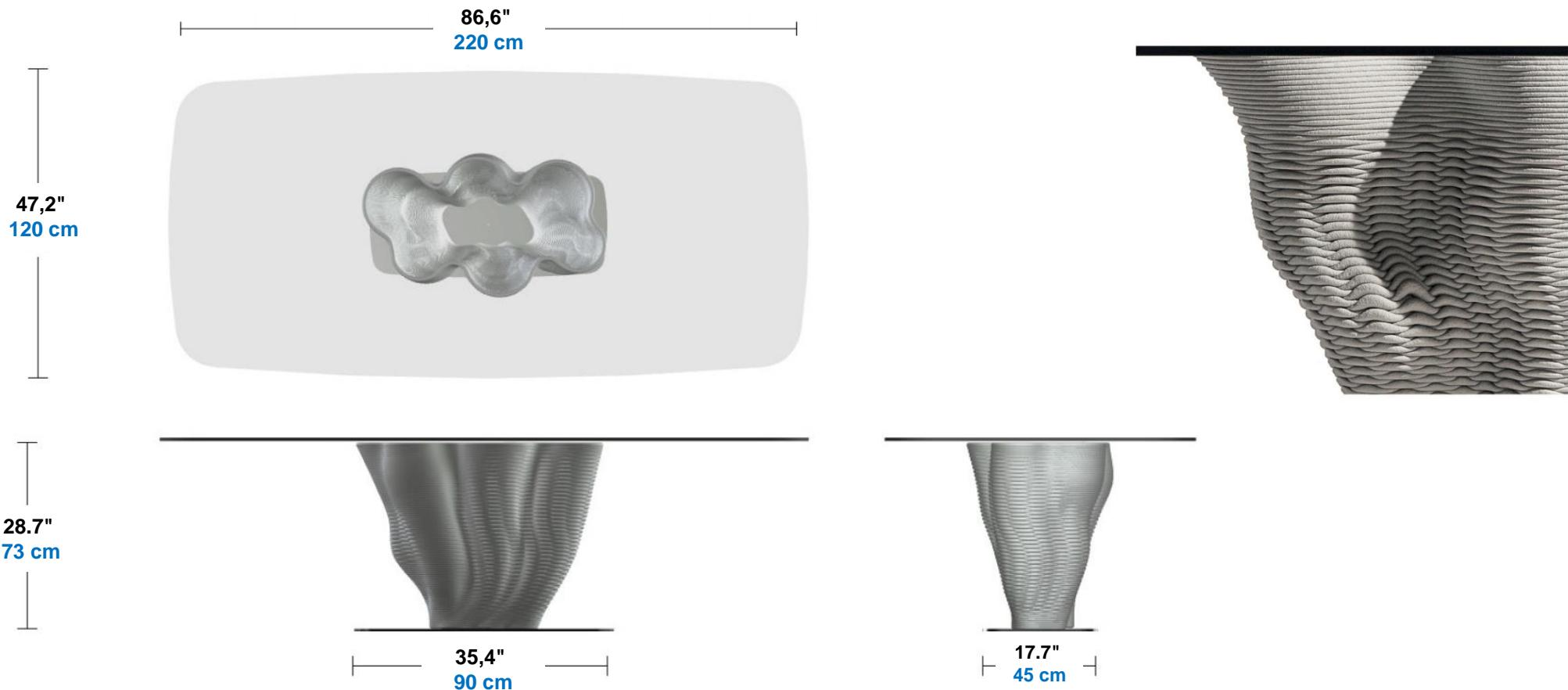
Table repas rectangulaire avec piétement réalisé par impression 3D de béton (BUHP), personnalisable en forme et texture. Platine en acier (laque époxy, 2 coloris), plateau en verre trempé ép. 15mm.
