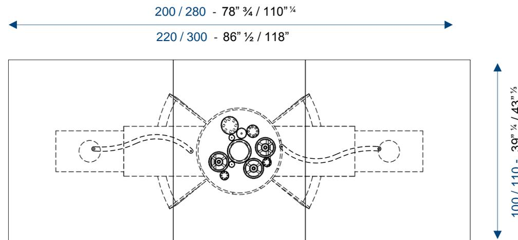
Table de repas avec une allonge centrale de 80 cm, motorisée avec mécanisme type horloger à engrenages apparents (batterie incorporée, télécommande).
